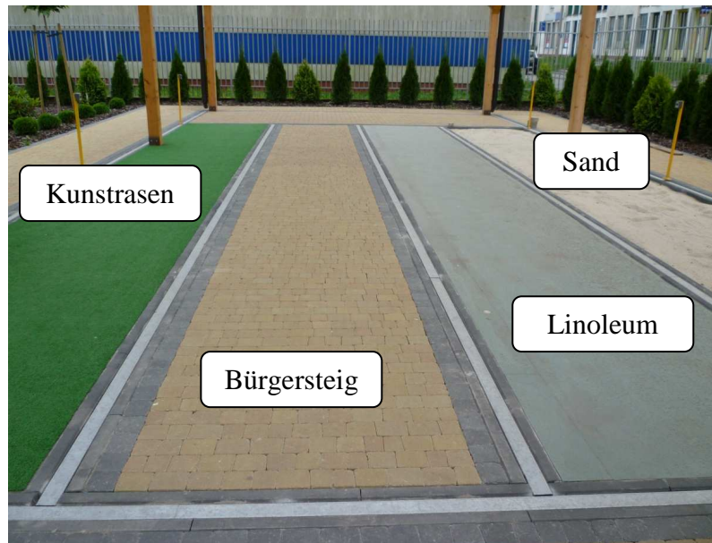
Bild 4. Teststrecke mit verschiedenen Gehunterlagen
